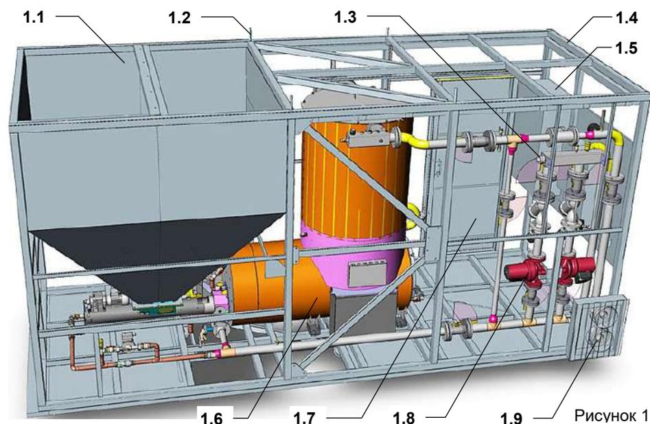
Котельные Терморобот поставляются в виде блоков заводской готовности, всё входящее в них оборудование смонтировано в рабочем положении и подключено согласно схемам.
